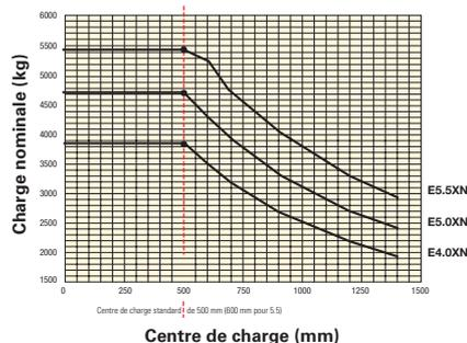
**Centre de charge :** Distance entre la face avant des fourches et le centre de gravité de la charge.
